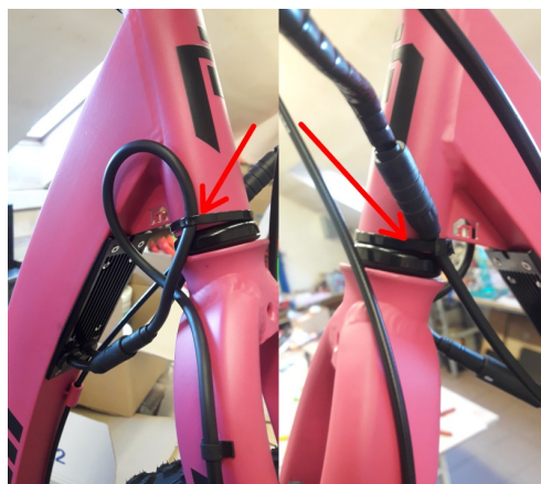
Obr 2: Uchycení kabelů pomocí stahovací náskvy
