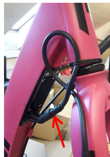
Obr.4: Spojení motorového konektoru a tří- a pěti-pinového konektoru od akcelerátoru a displeje
