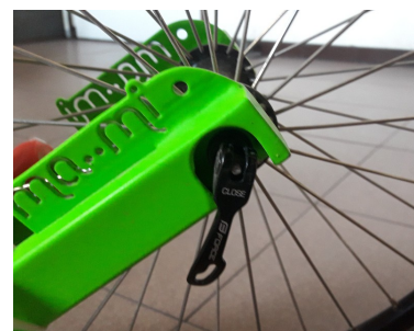
Obr.3: Nasazení a zajištění zadního kola
