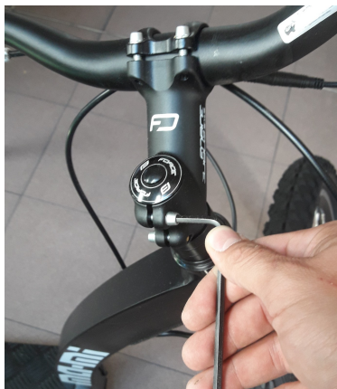
Obr 1: Nasazení vidlice, zajištění řídítek a nasunutí zadního brzdového lanka do pravé brzdové páky
